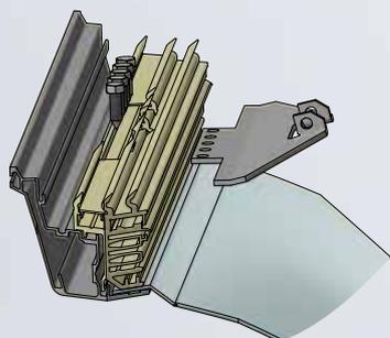
Gelenkbrücke durch vorgestanztem Schlitz geschoben und verschraubt (SKT-Bohrschraube 6,3 x 25 bzw. SKT-Bohrschraube 4,8 x 25, DIN7504-K)
